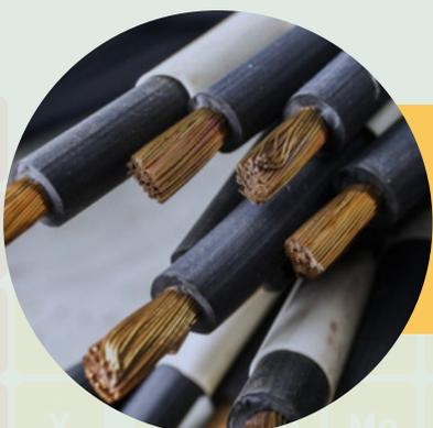
»»» Boa condutibilidade térmica, sendo muito utilizados como condutores de eletricidade, a exemplo do Cobre (Cu);
